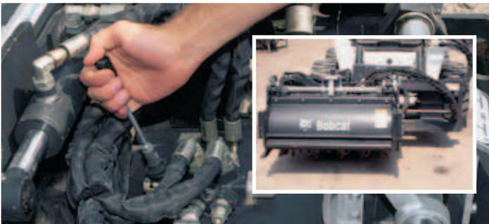
Utilisez l'inverseur pour sélectionner la commande hydraulique de l'oscillation ou du déport latéral.
