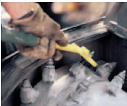
Le **panneau d'accès supérieur** est suffisamment grand pour permettre le remplacement des dents sans avoir à soulever la raboteuse ou retirer le tambour.
