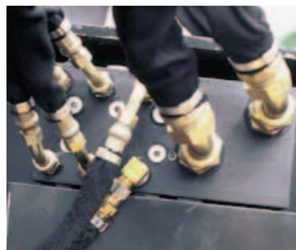
La raboteuse à cumul de débit est équipée d'une **valve prioritaire** permettant de dériver de l'huile pour les réglages de profondeur sans causer de perte de puissance momentanée du tambour. L'opérateur peut ainsi corriger à tout moment les réglages en cours d'opération.\*\*
