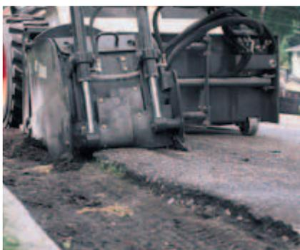
L'**oscillation** de la raboteuse garantit un suivi parfait des surfaces et l'isole des mouvements de la chargeuse sur les terrains irréguliers. Les patins de profondeur réglables permettent des coupes décalées, par exemple lorsqu'il s'agit d'ajuster deux revêtements irréguliers ou d'enlever la bordure d'un trottoir.
