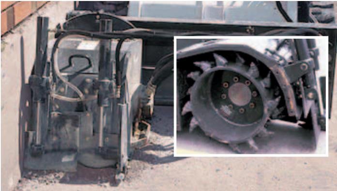
Le **patin** et la **plaque de fermeture** du côté **droit** sont amovibles afin de permettre le fraisage au ras d'un mur ou d'un trottoir (tambour 14", 16", 18" et 24"). Les dents d'attaque latérales évitent le blocage du tambour et produisent une bordure verticale afin d'améliorer les raccords.
