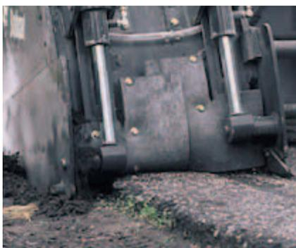
Les **patins** d'appui sont remplaçables. Ils permettent un contrôle constant de la profondeur en pénétrant dans les débris placés sur leur chemin. Il existe également un jeu de roues, disponible en option, pour remplacer les patins.
