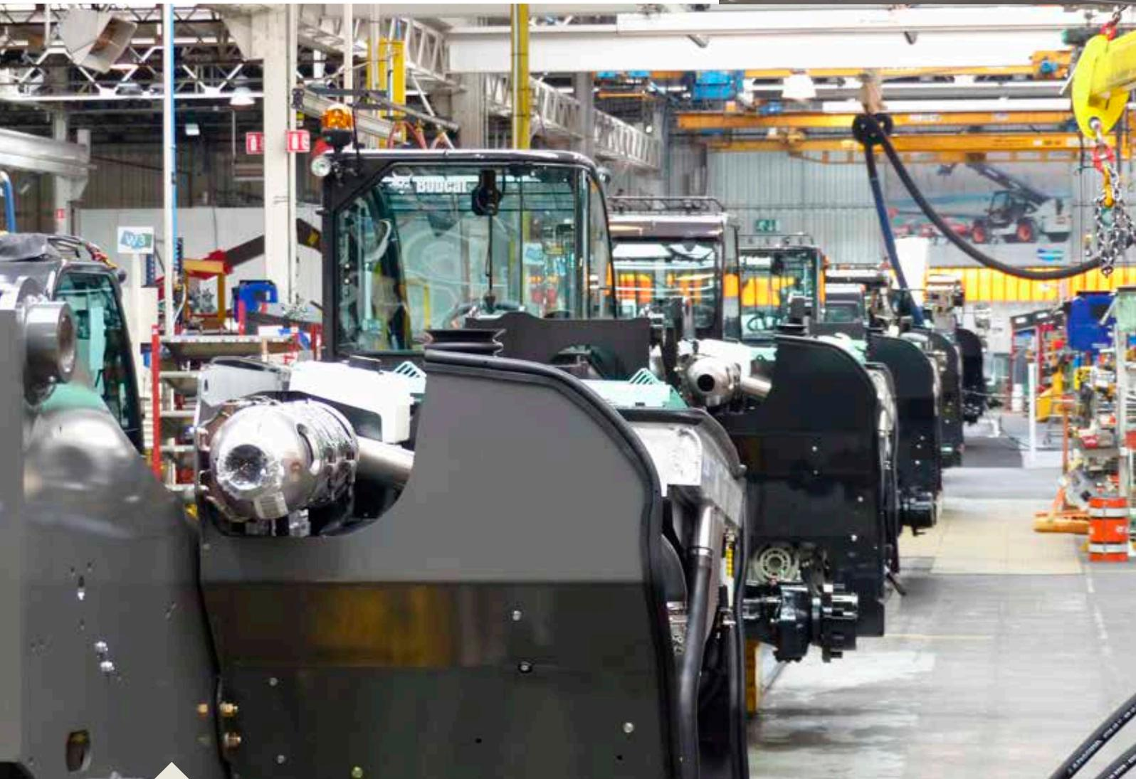
Bénéficiant d'un haut niveau d'intégration technologique depuis le soudage de la flèche et du châssis jusqu'à l'assemblage final des machines, notre productivité et la qualité de nos produits sont assurées par un équipement de production moderne comprenant des robots de soudage, une ligne de grenailage, une cabine de peinture à deux couches, ainsi que par une méthode d'intégration des meilleurs composants.
