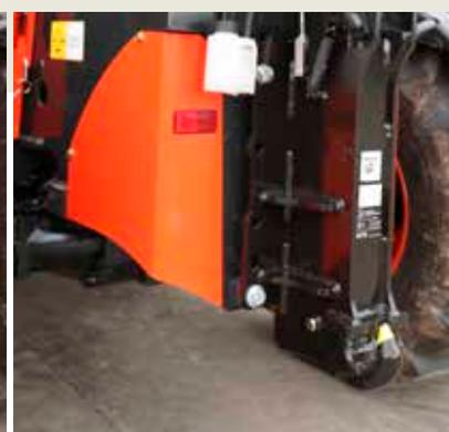
Crochet d'attelage à releveur hydraulique
