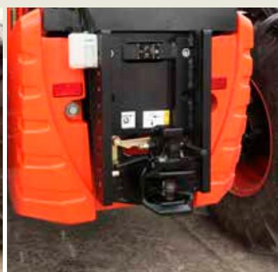
Crochet d'attelage rotatif avec réglage de la hauteur
