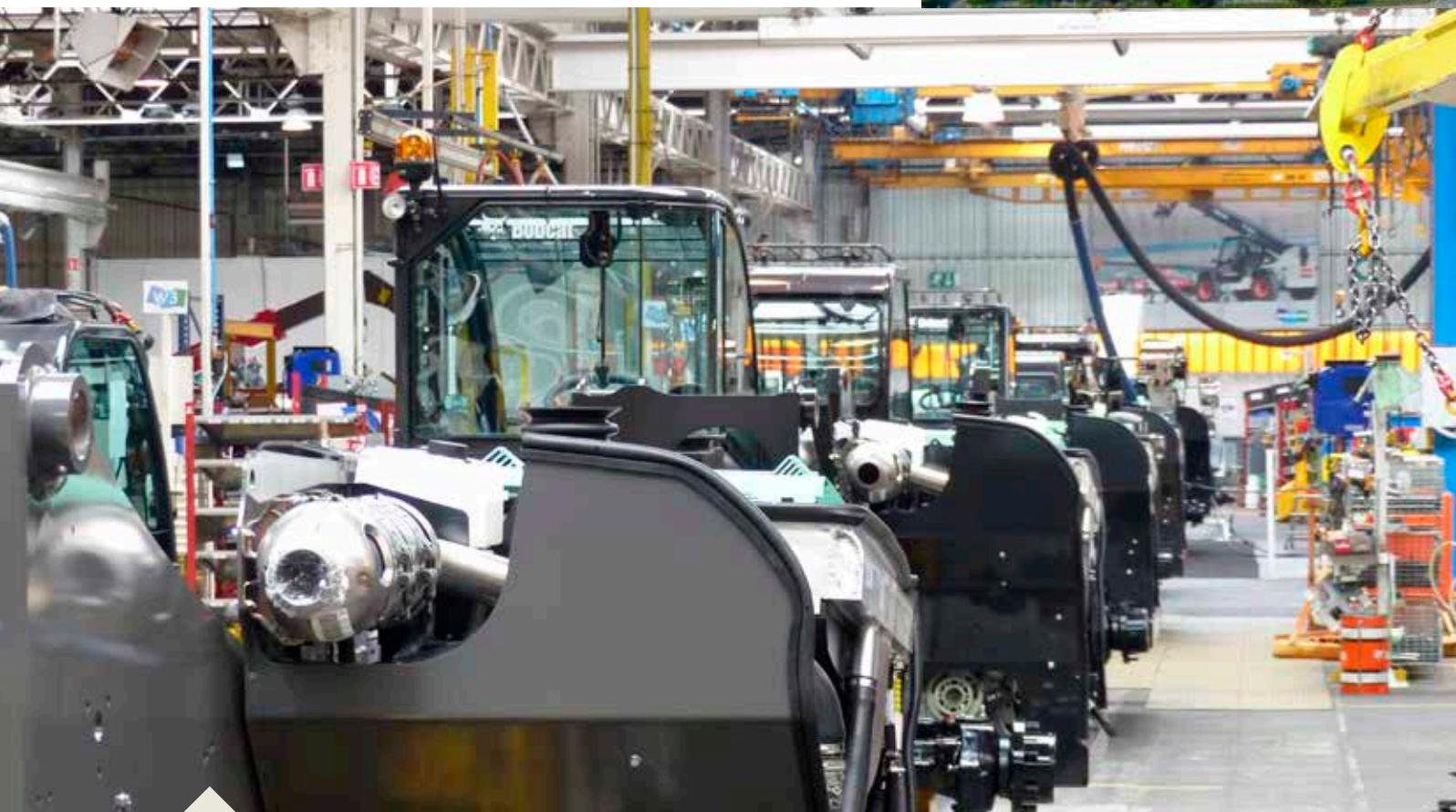
Bénéficiant d'un haut niveau d'intégration technologique depuis le soudage de la flèche et du châssis jusqu'à l'assemblage final des machines, notre productivité et la qualité de nos produits sont assurées par un équipement de production moderne comprenant des robots de soudage, une ligne de grenailage, une cabine de peinture à deux couches, ainsi que par une méthode d'intégration des meilleurs composants.
