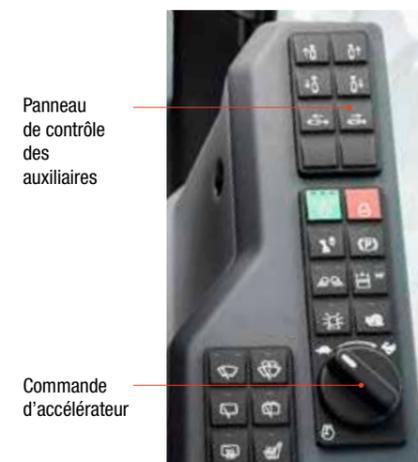
Panneau de contrôle des auxiliaires
