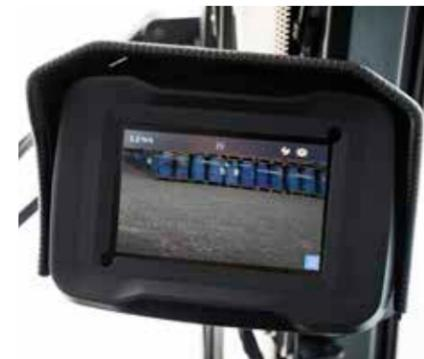
Commandé par le sélecteur, l'écran LCD affiche les informations vitales de la machine et bascule automatiquement sur la diffusion de la caméra de recul quand vous passez en marche arrière.
